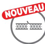
Languette débordante adhésive intégrée pour garantir la continuité de l'étanchéité à la jonction des panneaux, sans ajout de membrane et sans adhésif séparé.
